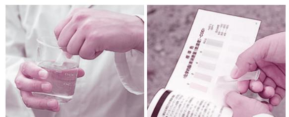
③穴のあいたほうを水につけ、④振り混ぜて反応させ、指定チューブに水を吸いあげる。時間後に色見本と比較する。
