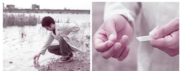
①川の水を採取し、水温を測定する。 ②チューブ先端のピンを引き抜き、内部の空気を出す。
