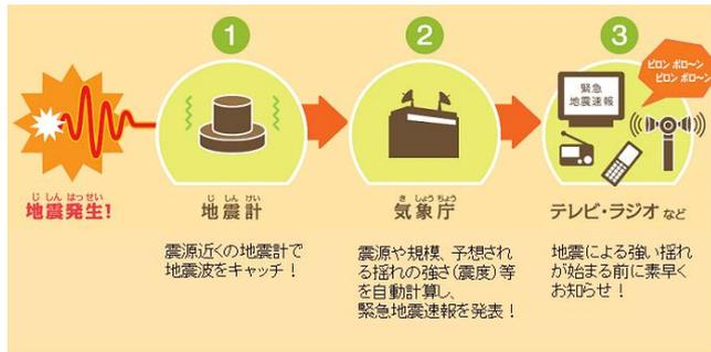
▲図13 緊急地震速報の仕組み
